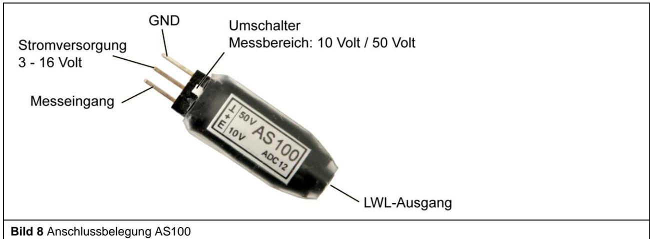
Bild 8 Anschlussbelegung AS100
