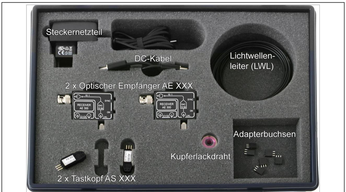
**Bild 12** Koffer Analog Set zweikanalig
